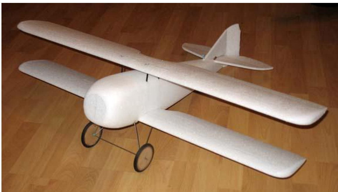
poprvé sestavený model, podvozek naohýbán jen z obyčejného drátu do kola o průměru 2mm
