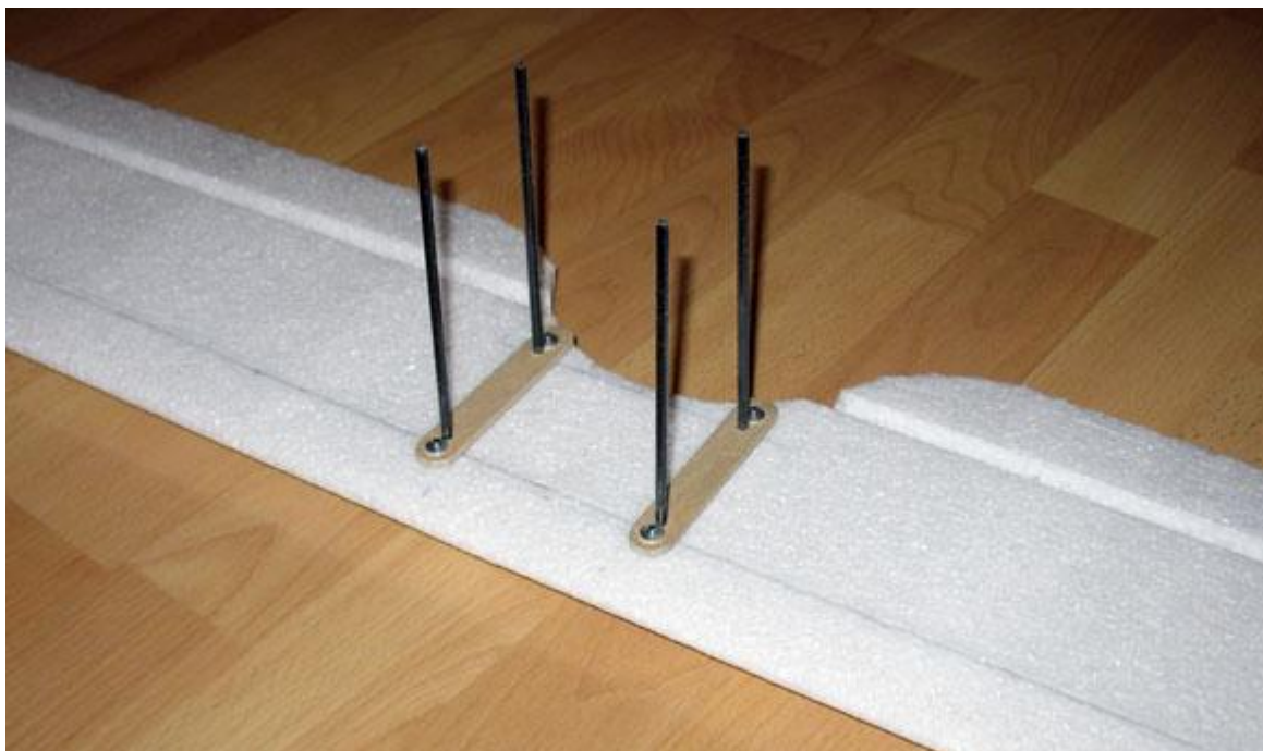
celková sestava kozlíku - dva překližkové pásy, čtyři uhlíkové trubičky 4/2
