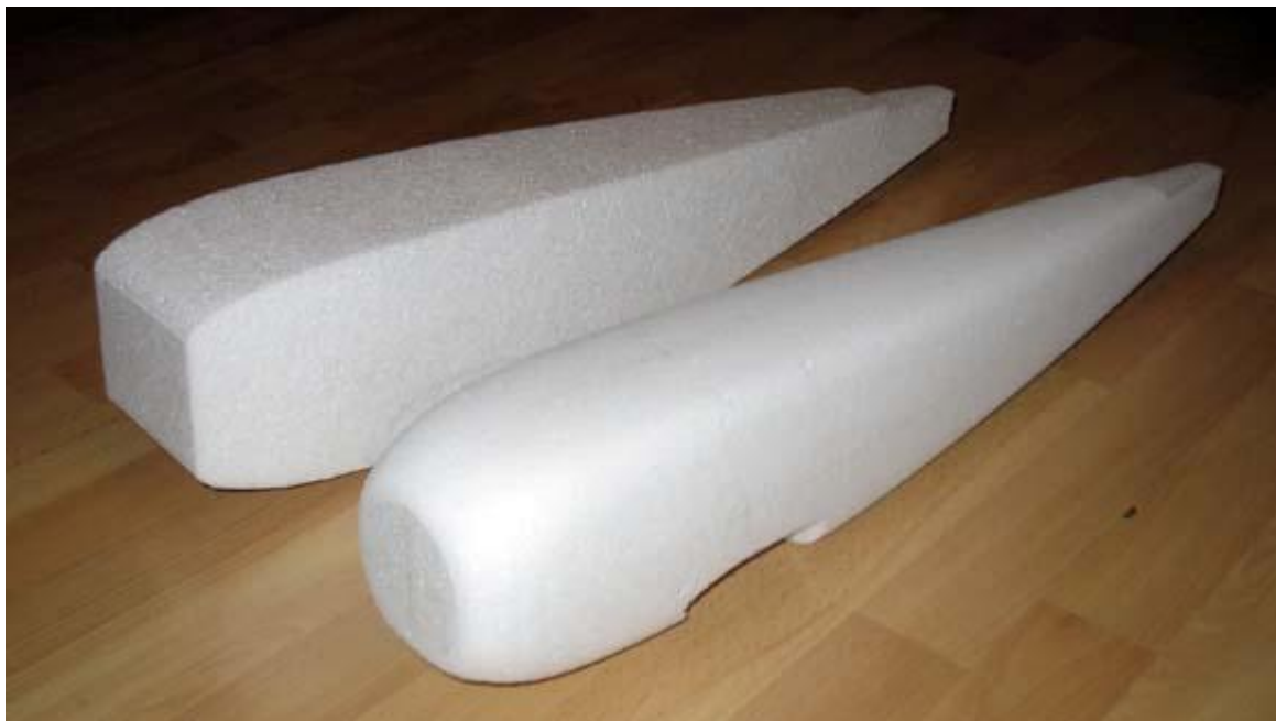
pro srovnání polotovaru a vybroušený trup
