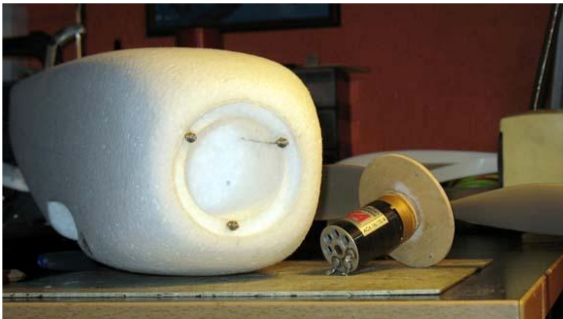
otvor pro motor je vyříznut trubkou (nádobka od aktivátoru ve spreji), nožem je doříznuto kruhové osazení pro zapuštění přepážky, přepážka je kotvena ve třech bodech
