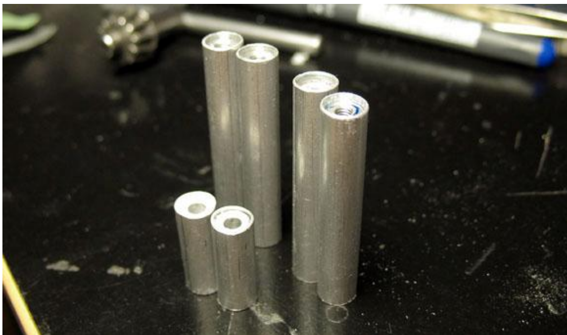
díly uchycení křídel - vpředu průchodky, vzadu "matice" kotvení spodního křídla
