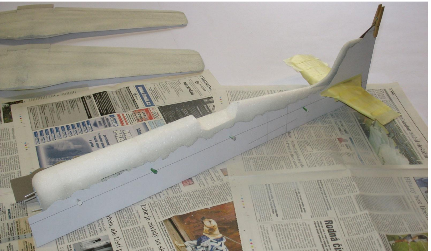
foto: přechod barev na trupu je stříkán přes šablonu z kartonu
