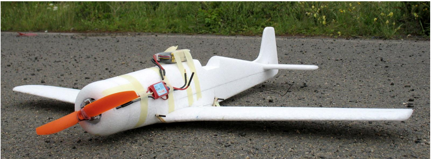
foto: model osazený pro zalétnutí, regulátor a baterie jsou připevněny provizorně papírovou lepicí páskou
